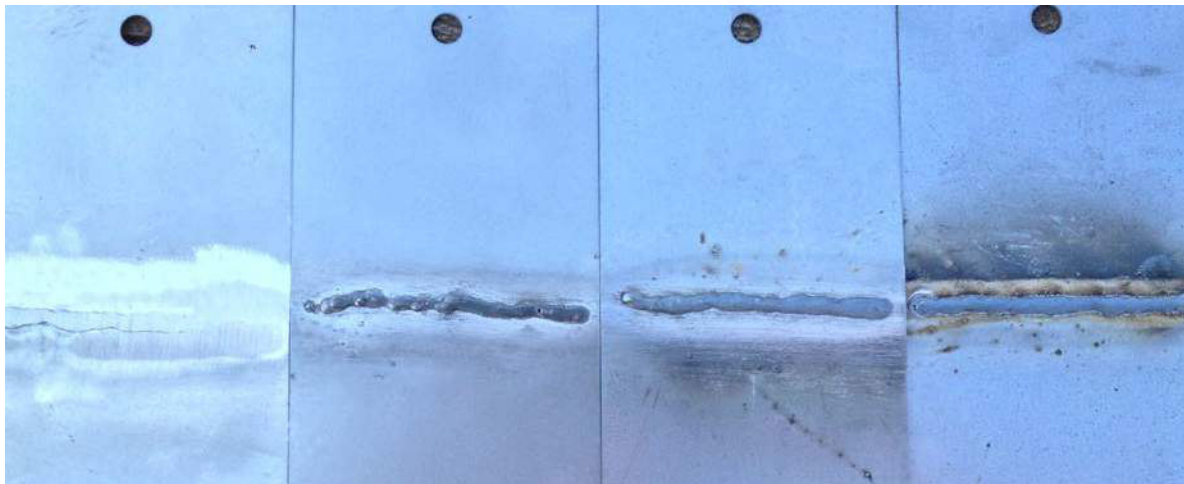
Abbildung 12: Schweißnähte in absteigendem Reinigungsgrad
